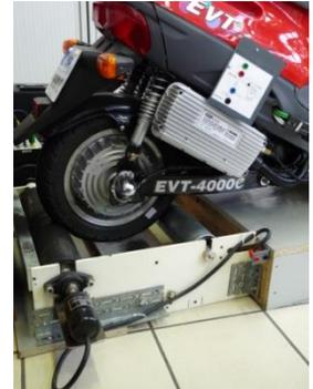
**D3.** Mettre en œuvre les appareils pour relever la tension issue de la DT pour un angle correspondant à la vitesse maximale. Imprimer le relevé et déduire le type de réponse ainsi que les caractéristiques associées.
