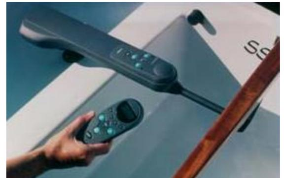
Le pilote est fixé en deux points au bateau (cockpit et barre).
