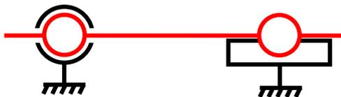
La modélisation choisie est ici **isostatique**, la réalisation des pièces ne présente **aucune contrainte**.
