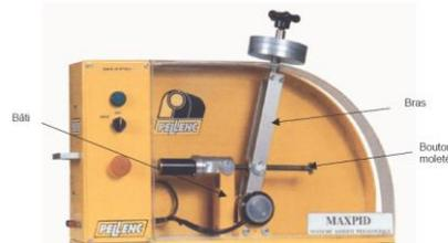
La chaîne fonctionnelle MAXPID est un sous-ensemble extrait de ces robots automatisés développés par la société PELENC.
