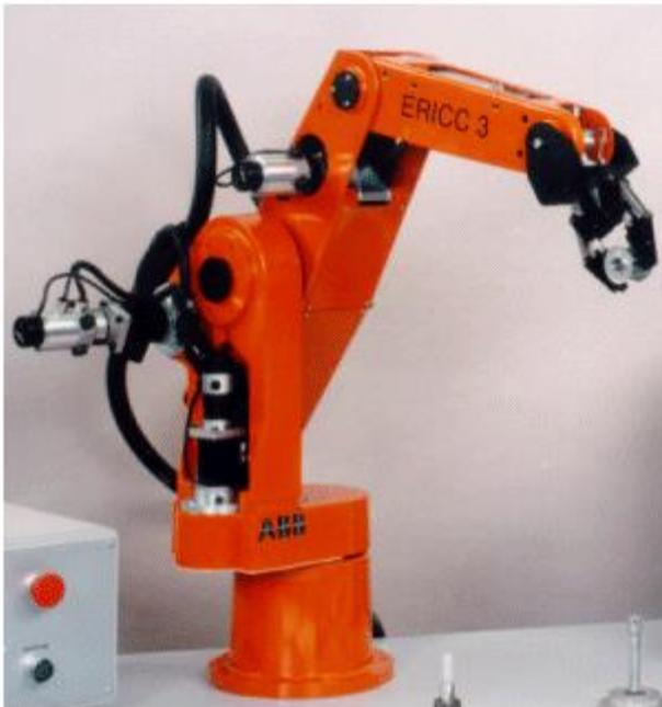
Le robot Ericc 3 est un robot ayant 5 axes de rotation. Ce robot anthropomorphe est utilisé en entreprise pour de nombreuses tâches différentes : collage, soudage, peinture, manutention de pièces...
