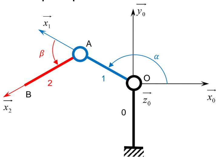
**L'objectif est de déterminer la position du point B (extrémité du robot) par rapport au repère lié au bâti**
