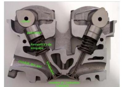
**L'objectif de l'étude est de déterminer la vitesse de glissement au niveau du contact soupape excentrique, cette vitesse de glissement crée un échauffement au niveau du contact et ainsi une baisse de la résistance des matériaux.**
