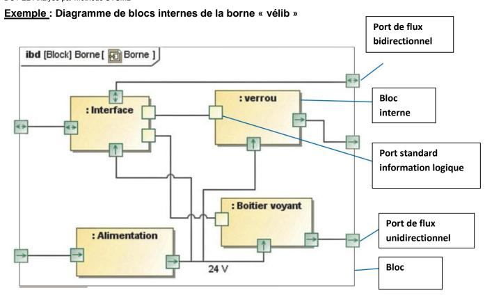
Un diagramme de bloc interne représente l'intérieur d'un bloc issu du diagramme de blocs (pas interne celui-là). On voit ainsi apparaitre les échanges entre blocs de même niveau (blocs qui ne se contiennent pas entre eux) comme ci-dessous :
